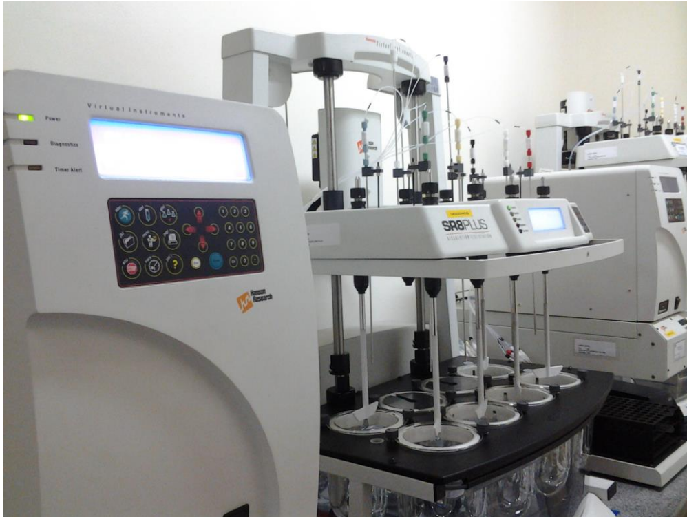
Figura 5 - Aparelho dissolutor modelo SR8 PLUS da marca Hanson Research. Localizado no Laboratório Químico Farmacêutico da Aeronáutica.
