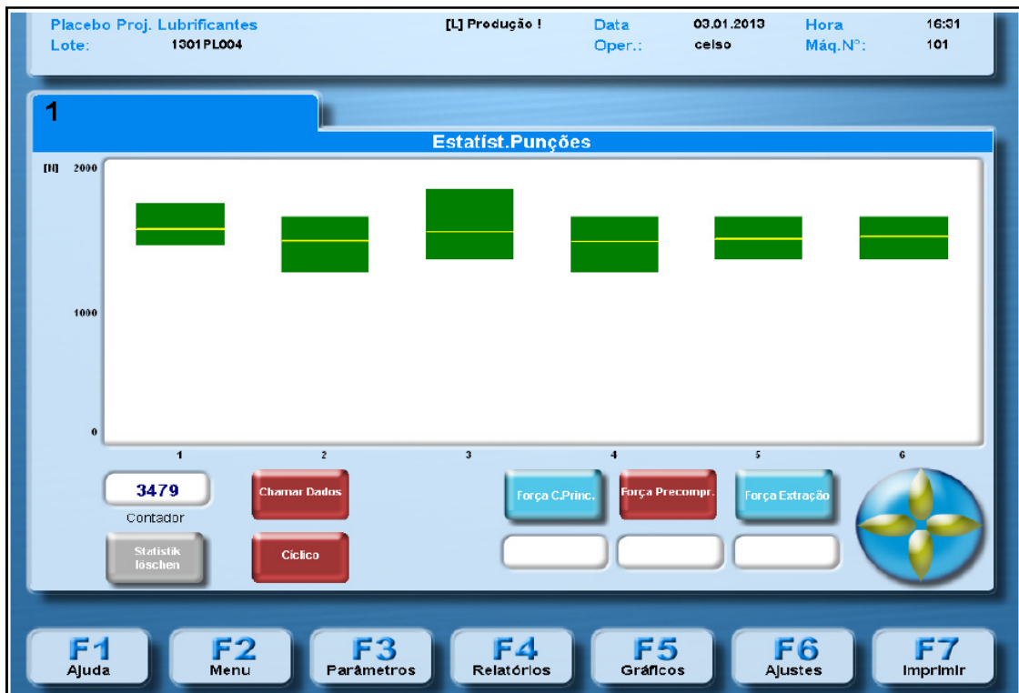
Figura 20: Exemplo de gráfico estatística dos punções para os valores de força de pré-compressão.
