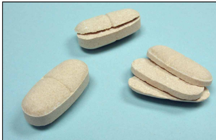
Figura 7: Capping em comprimidos oblongos (Disponível em: < http://en.wikipedia.org/wiki/File:Tabletfailure.jpg >. Acesso em: 10 abr. 2013).
