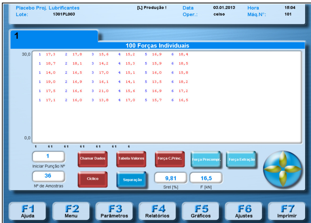
Figura 15: Exemplo de gráfico das 100 forças individuais em valores absolutos mostrando 36 forças de compressão principal.
