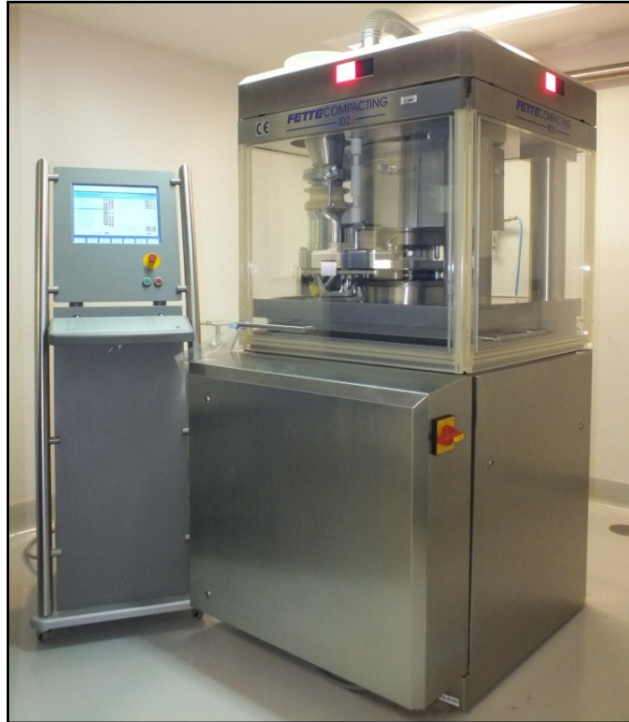
Figura 13: Compressora Rotativa Fette 102i.
