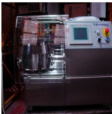
Figura 16: Granulador por alto cisalhamento Granuliti 5 e Granulit 400 + CroMill UD 8".
