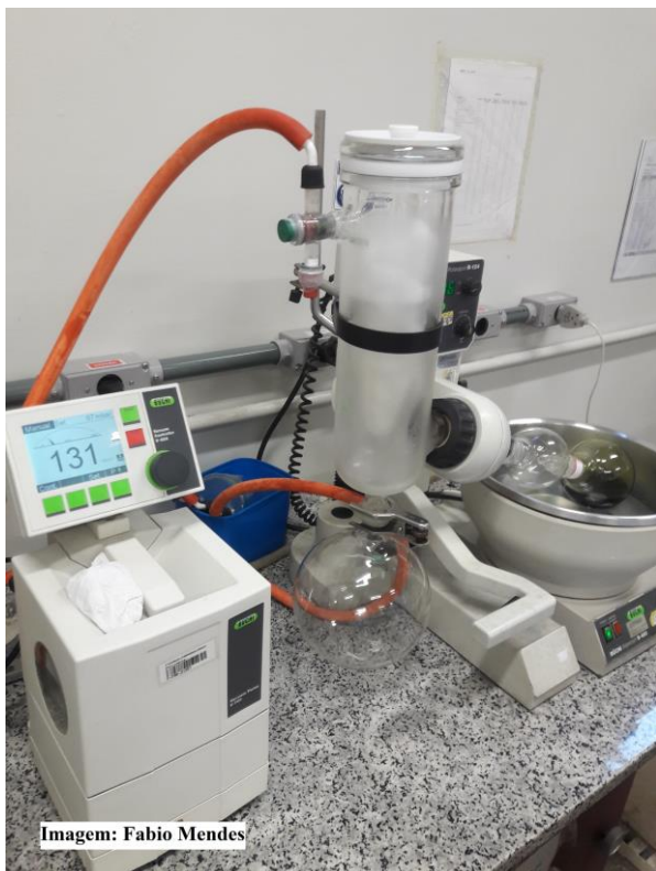
Figura 6- Etapa de rotaevaporação dos extratos
