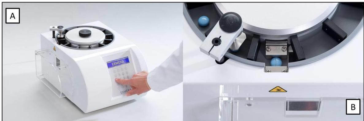
**Figura 27** - Durômetro ERWEKA (A) utilizado para os ensaios de dureza, peso individual e médio e espessura dos comprimidos. No detalhe (B) exemplo da ruptura de um comprimido.
