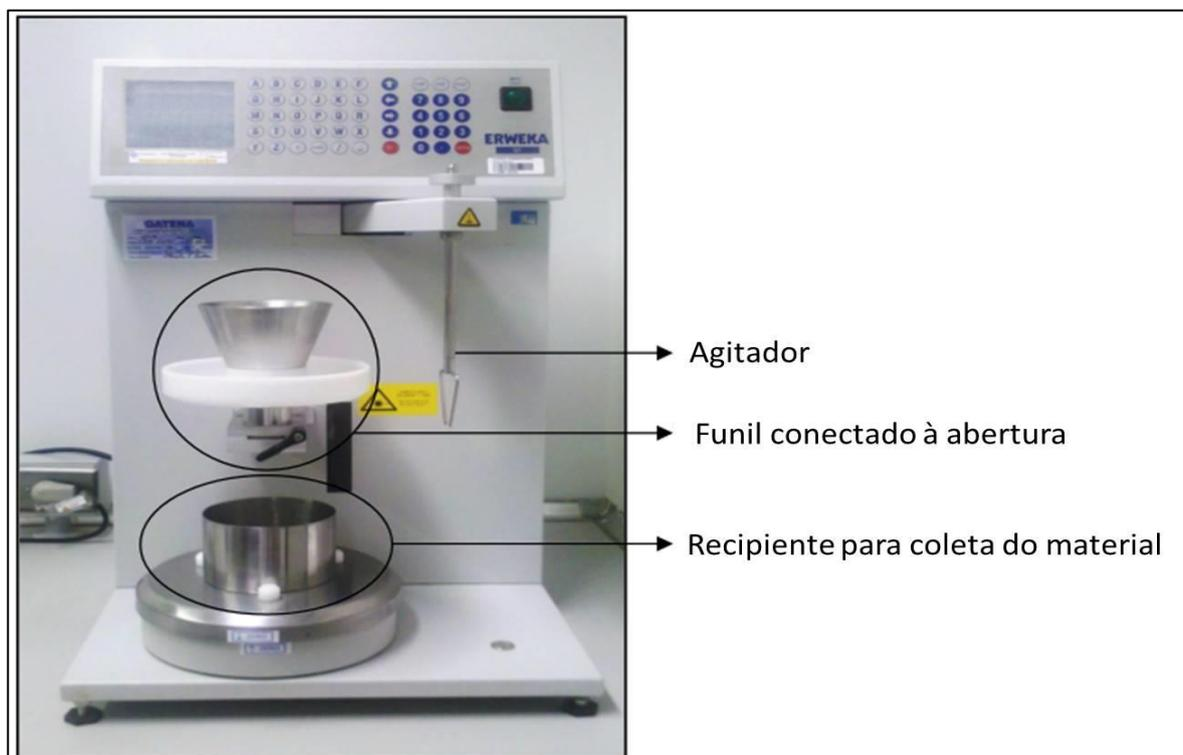
**Figura 25** - Equipamento Granulate Flow Tester GT, modelo GT-B.
