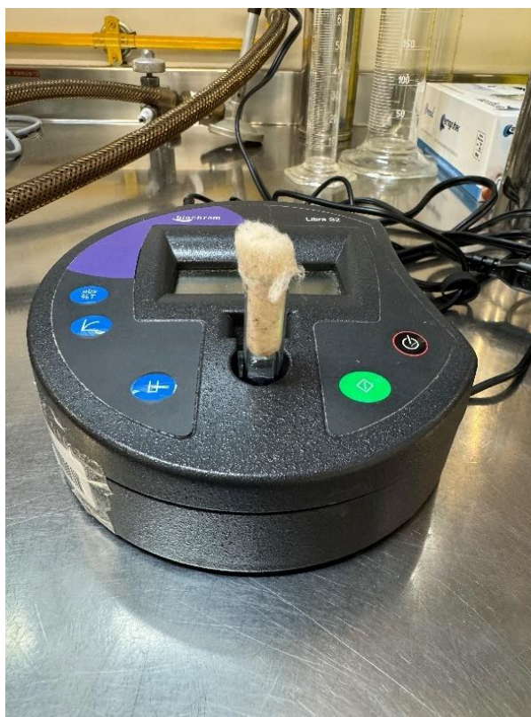
Figura 2 – Leitura em fotocolorímetro em comprimento de onda de 520 nm
