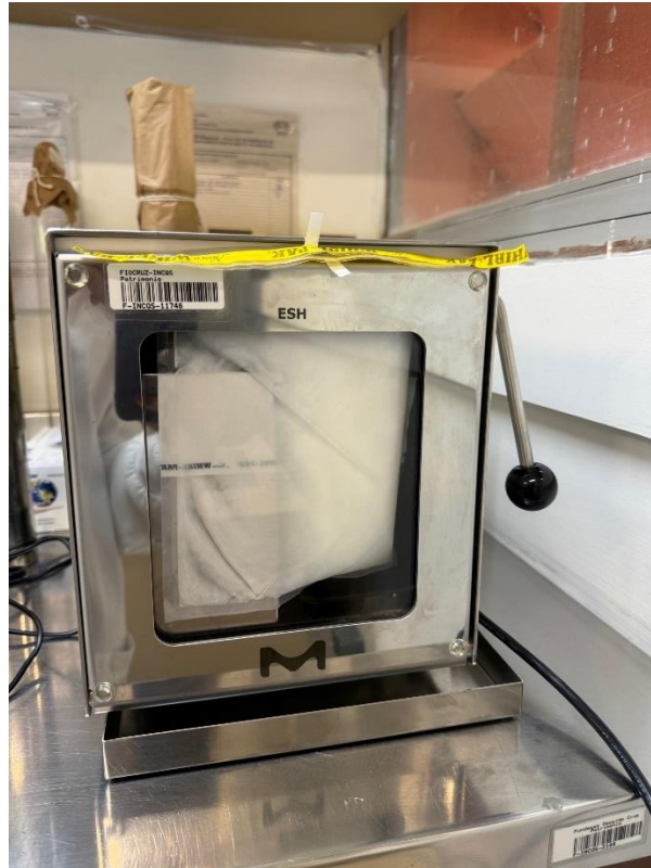
Figura 5 – Amostra sendo homogeneizada em aparelho homogeneizador de amostras
