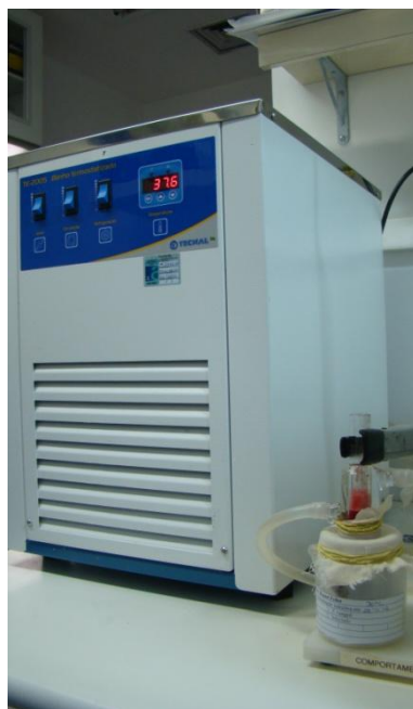
Figura 4 - Alimentador artificial: alimentadores de vidro conectados ao banho-maria com circulação interna e externa de água, com sensor de temperatura (Foto: M a Raquel Fellet).
