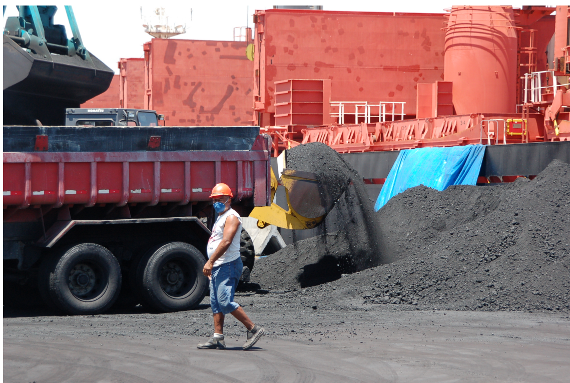
Figura 11 – Sistema de desestiva do coque verde de petróleo de navio em sistema aberto, com dispersão do pó no entorno. Porto de Suape, Cais 1, 14/12/2008. Fonte: Gondim (2008a).
