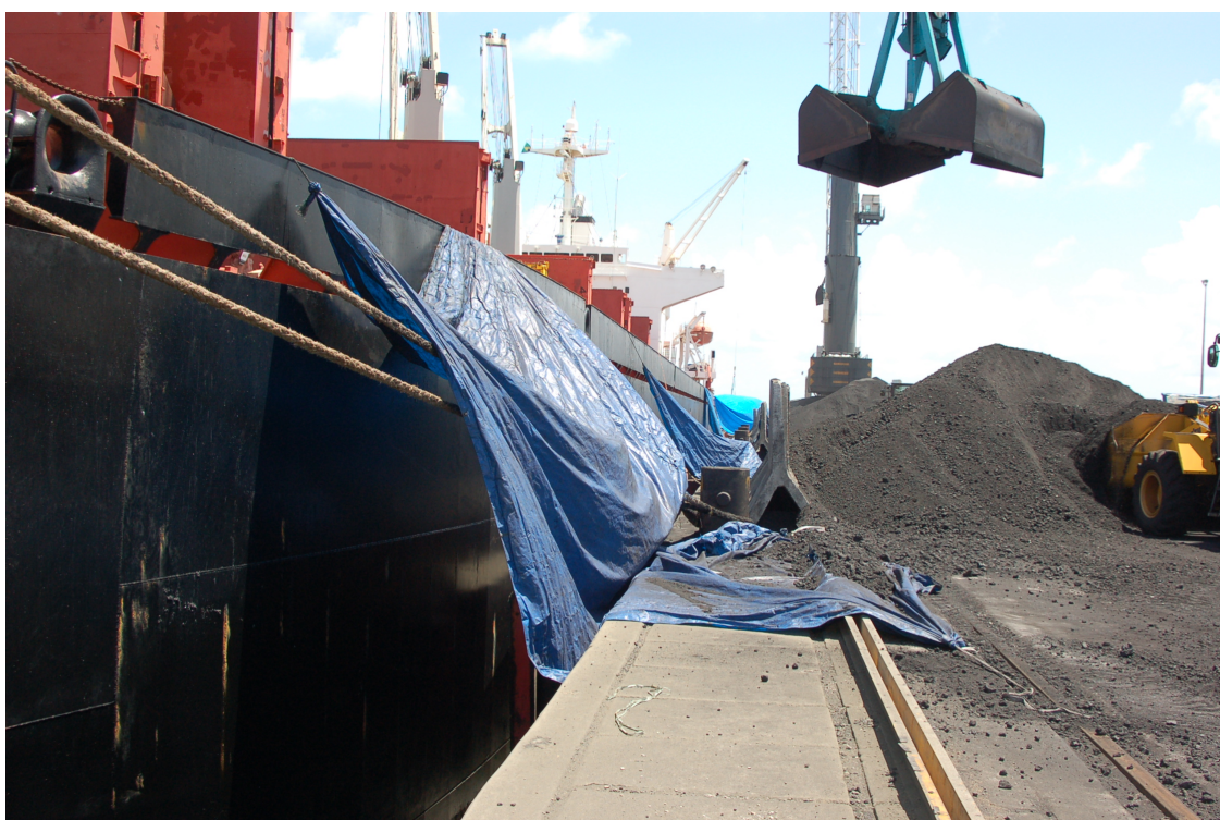
Figura 14 – Transferência do coque dos navios para a área portuária com utilização de lonas improvisadas na tentativa de reduzir o espalhamento do produto. Porto de Suape, Cais 1, 14/12/2008. Fonte: Gondim (2008b).
