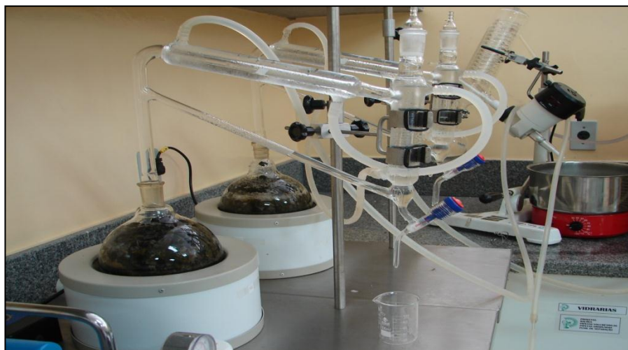
Figura 16 - Sistema de hidrodestilação aparelho de Clevenger
