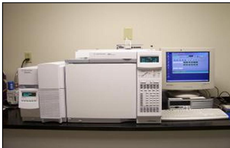
Figura 17 - Cromatográfico gasoso acoplado a espectrômetro de massas (CG/MS)
