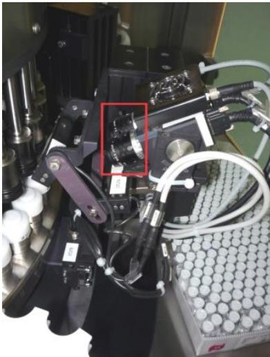
**Figura 21** – tele câmera dupla para inspeção de frascos. Fonte: o autor.
