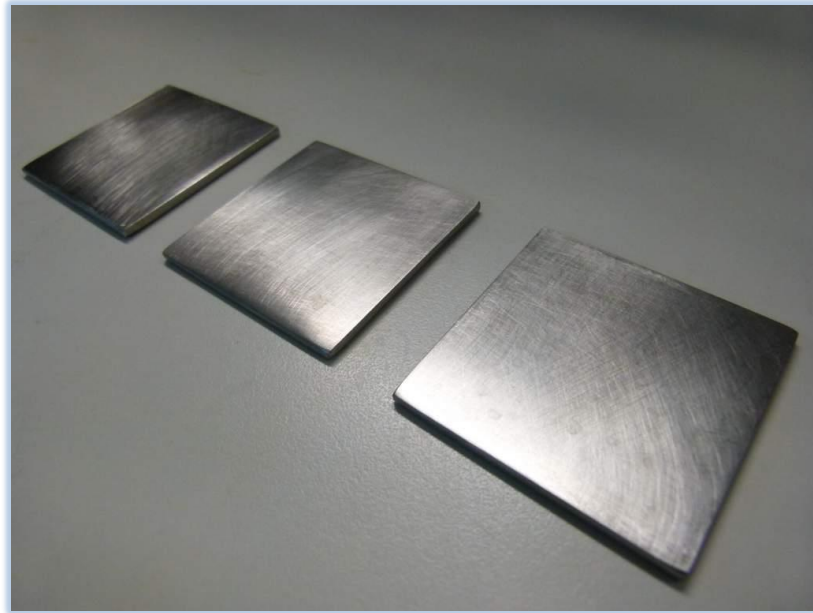
Figura 5 - Placas de aço inox 316L, com 25 cm 2 de área
