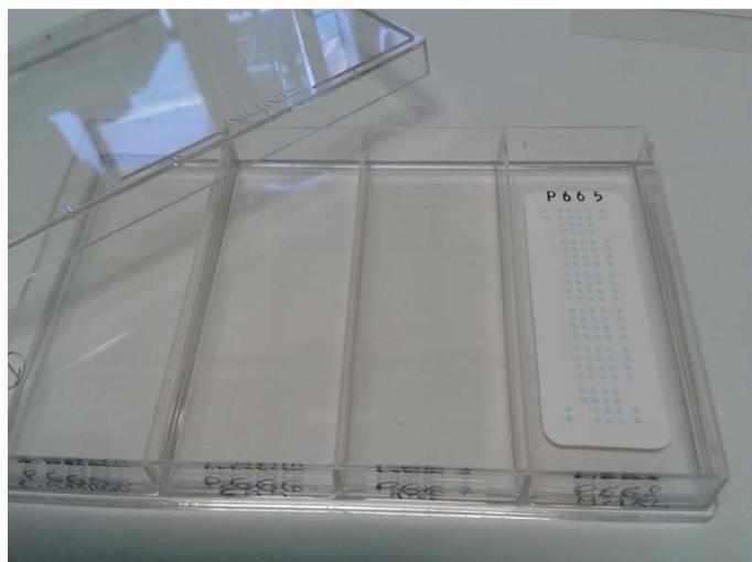
**Figura 19: Membrana de nitrocelulose e câmara multilavagem do *Human Angiogenesis Array Kit*.**
