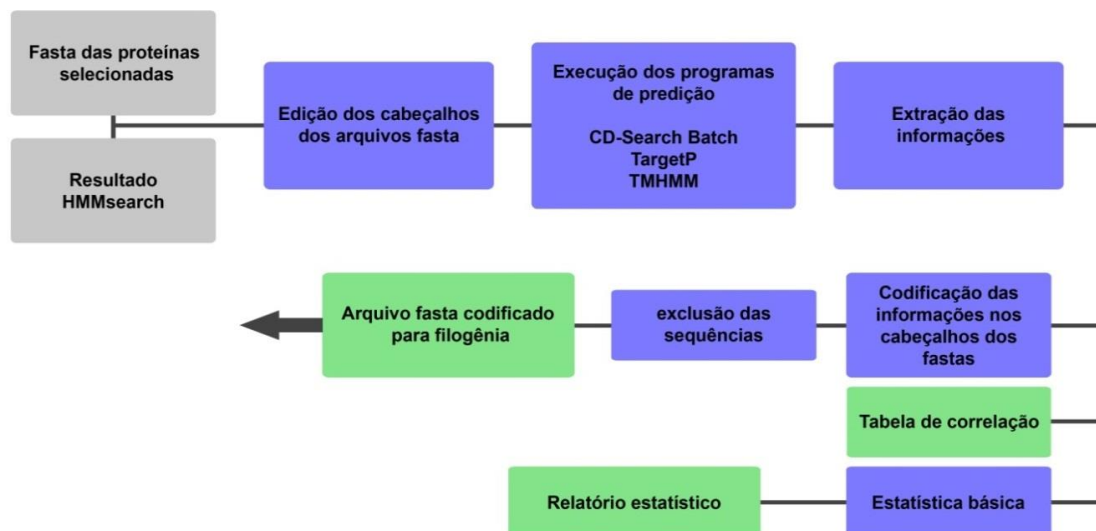
Figura 3.14 Esquema do pipeline usado para executar os programas de predição e editar os resultados de forma codificada nos cabeçalhos dos arquivos em formato FASTA. Os retângulos cinzas, azuis e verdes representam respectivamente os arquivos que são gerados pelo pipeline FAT, os scripts e programas executados e os arquivos gerados.
