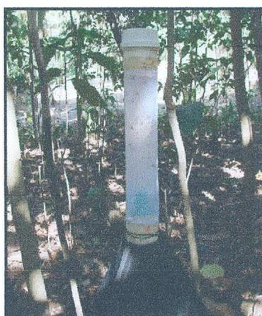
Figura 4.7 – Tubo coletor constituído por um tubo de PVC que, em sua porção mediana, apresenta uma janela coberta com tecido de náilon fino branco que permite a entrada de luz e ar para dentro do tubo.
