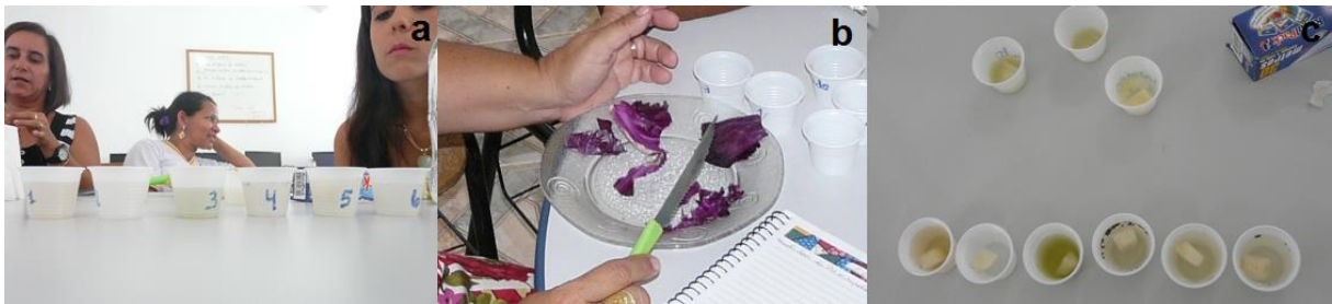
Figura 23 – Verificação do pH da água da Lagoa e da água da Serra. a- Amostras de água da Lagoa e água da Serra. b- Repolho roxo como indicador de pH. c- Amostras com resultado do experimento.
