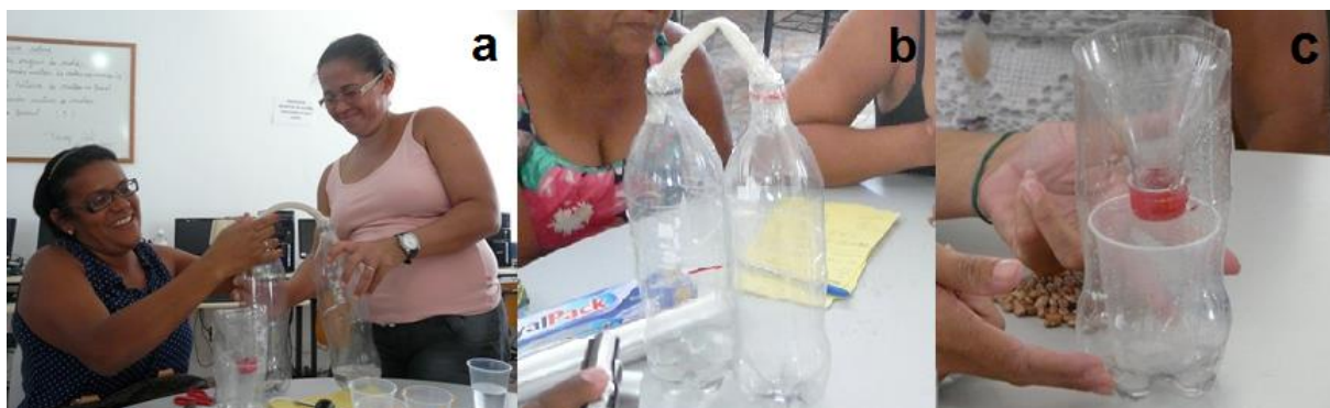
Figura 25 – Experimento para dessalinizar a água. a- Montagem do experimento com o uso de garrafas plásticas e pedaço de mangueira . b- Resultado do experimento evidenciando a dobra da mangueira como barreira na passagem do vapor da água. c- Resultado do experimento com a água dessalinizada no copo descartável.
