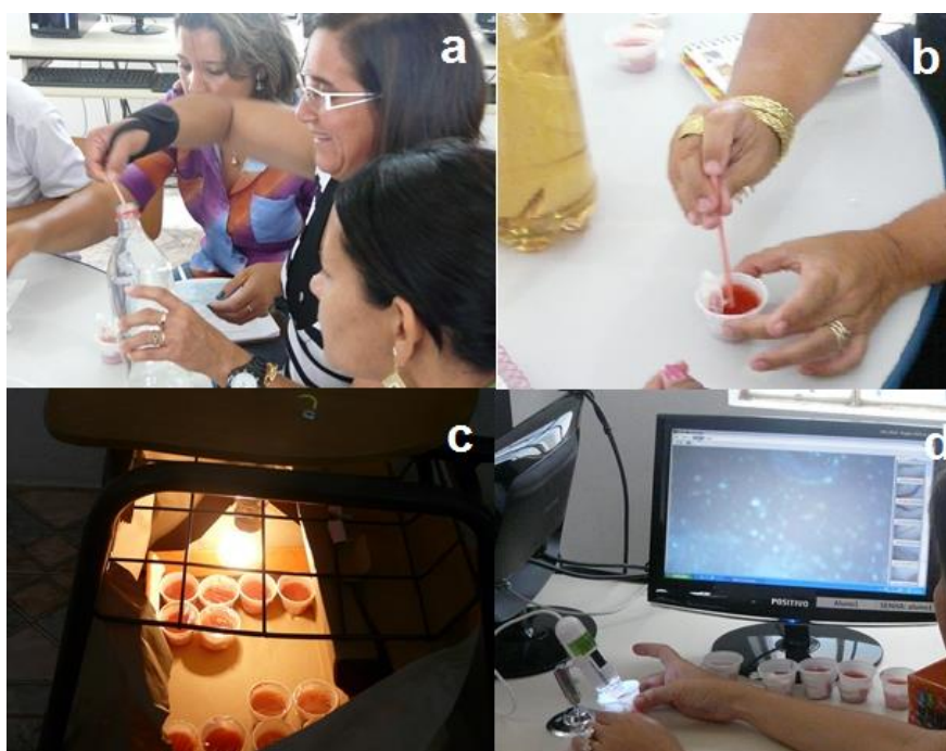
Figura 21 – Verificação experimental da água da Serra e da água da Lagoa. a- Professora do Ensino Fundamental do Município de Miguel Calmon – BA realizando experimento. b- Água da Serra sendo pipetada. c- Estufa artesanal. d- Crescimento fúngico ou bacteriano observado por microscópio.
