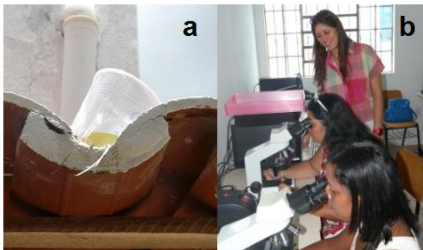
Figura 22 – Experimento SODIS com a água da Lagoa. a- Experimento exposto à radiação solar. b- Verificação do resultado do experimento no microscópio.
