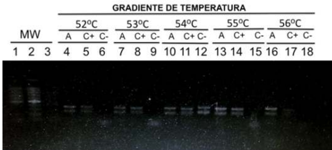
Figura 2 - Fotografia mostrando amplicons após corrida eletroforética em gel de agarose 1,5%, corado com Brometo de Etídio 0,1% para mostrar o gradiente de temperatura entre 52oC a 56oC.
