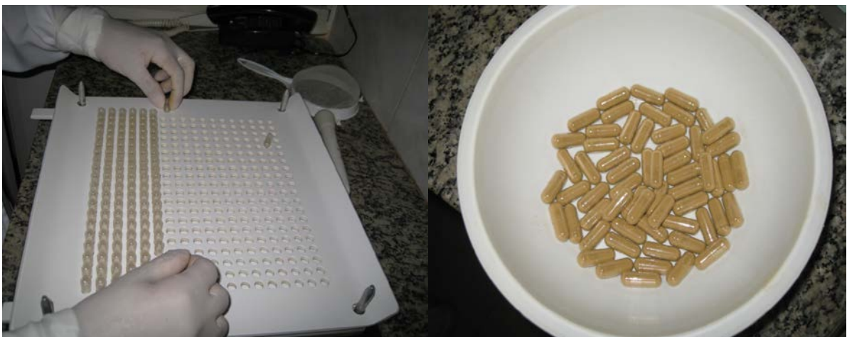
Figura 04 - Ilustração de parte do processo de preparo das cápsulas e aspecto das cápsulas de hipromelose.
