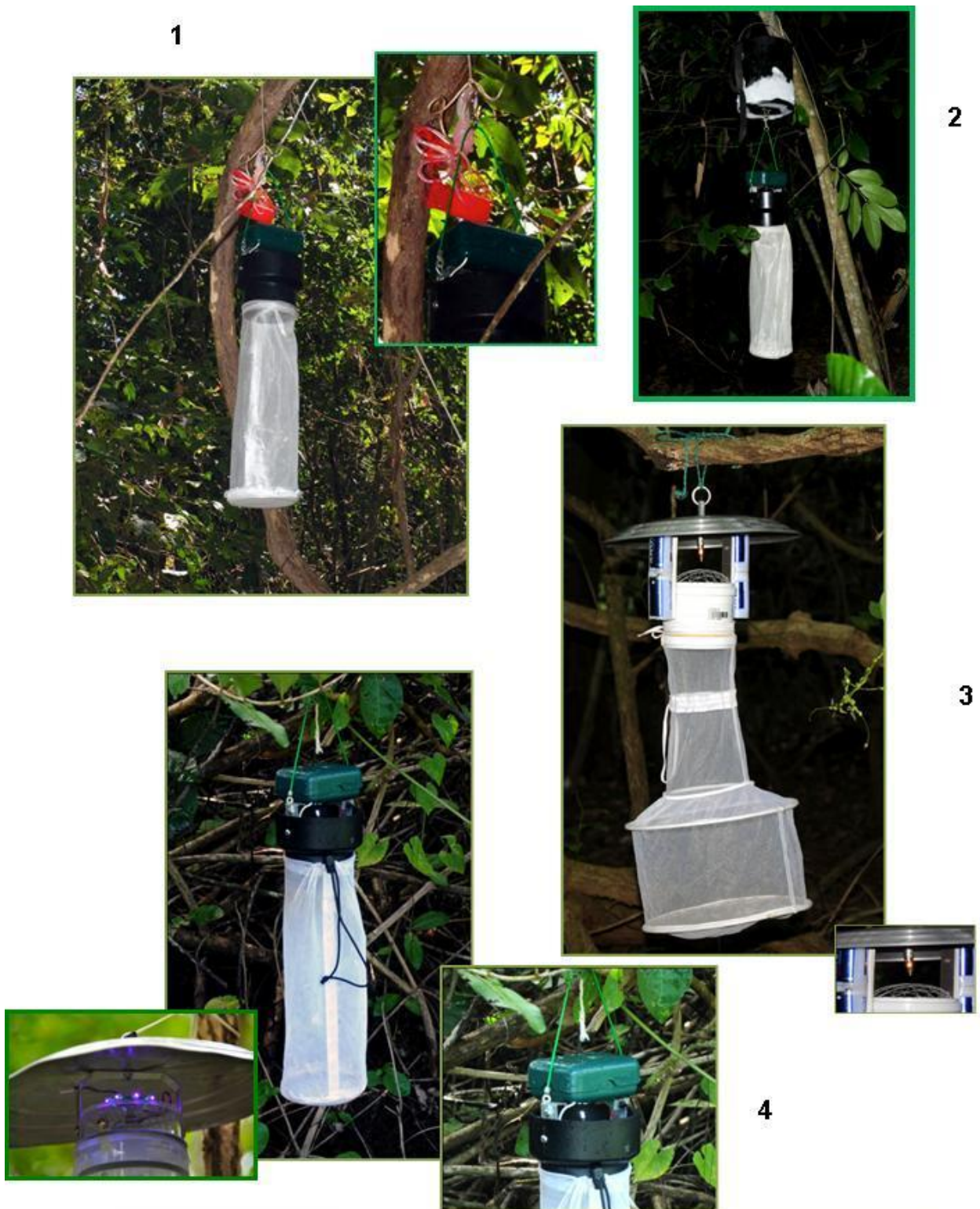
Figura 3. Armadilhas luminosas tipo CDC utilizadas para captura de mosquitos no entorno do reservatório da UHE São Salvador: 1- CDC com atrativo humano (Lure- diurna e noturna); 2- CDC a base de gelo seco (diurna); 3- CDC com luz incandescente (noturna); 4- CDC com LED (noturna).
