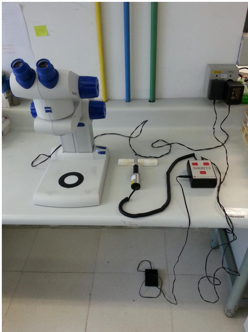
Figura 13: Fotografia ilustrando o aparelho Nanoject II™ para microinjeção.
