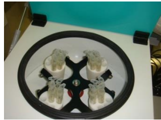
8. Centrifugação a 3.000 rpm (1249,92 x g) por 5 minutos
