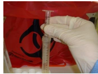
7. Tubo de 15 mL e seringa de 3 mL sem êmbolo e transferência do disco 3 mm
