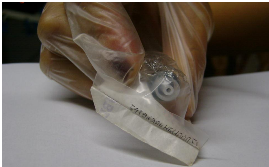
Figura 9 - Foto de uma seringa apresentando não conformidade no local de abertura da embalagem
