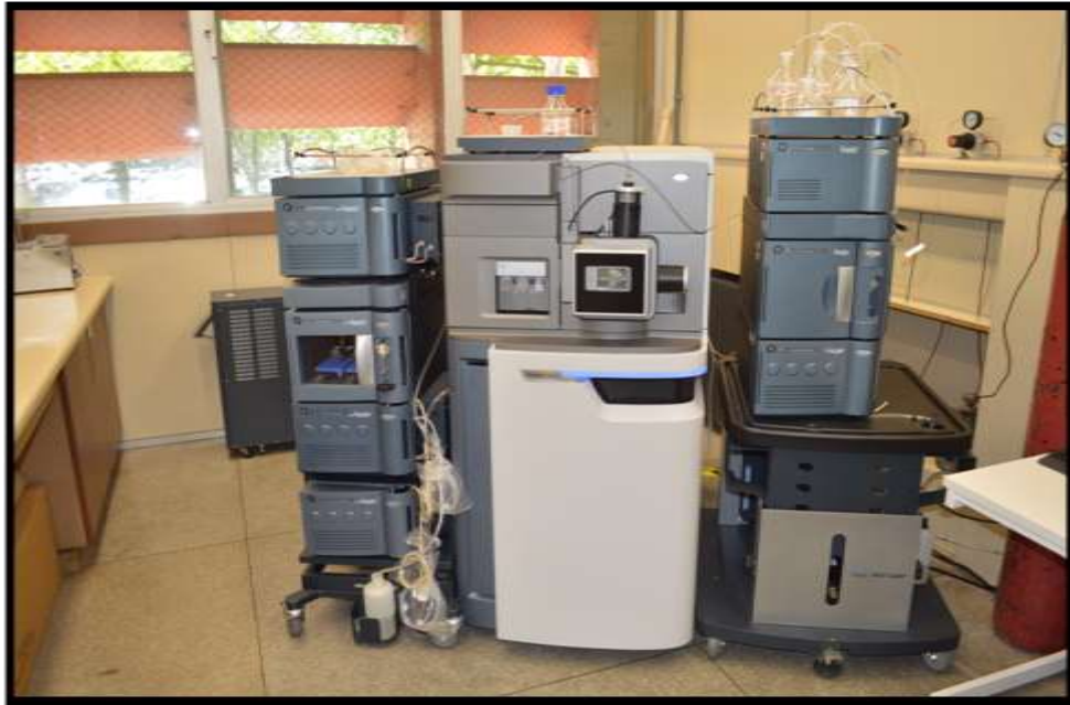
Figura 7: Cromatógrafo líquido de ultra eficiência acoplado ao espectrômetro de massas modelo SYNAPT G2-S HDMS fabricado pela Waters® Corporation.
