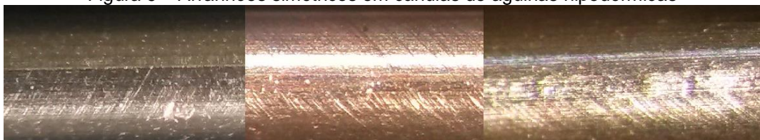
Figura 9 – Arranhões simétricos em cânulas de agulhas hipodérmicas
