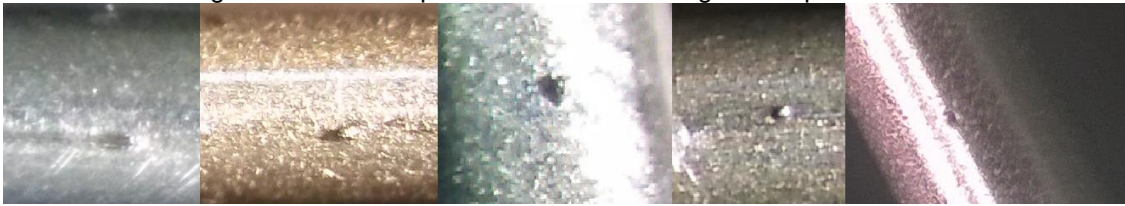
Figura 12 – Pontos pretos em cânulas de agulhas hipodérmicas
