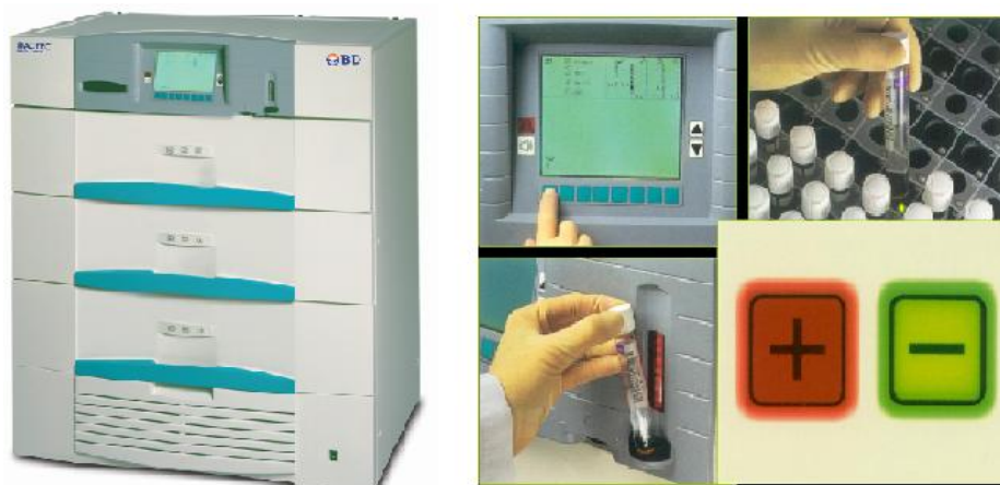
Figura 3-3 Equipamento automatizado para cultivo de micobactérias em meio de cultura líquida, método BACTEC MGIT 960 (Mycobacteria Growth Indicator Tube).
