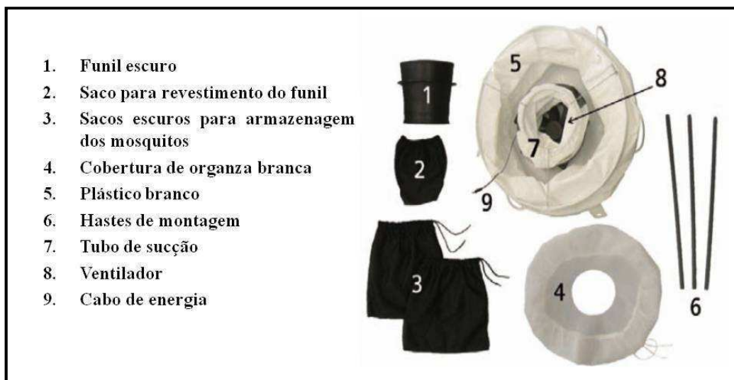
FIGURA 7: Armadilha BG-Sentinel Full Version ® desmontada e seus respectivos componentes.
