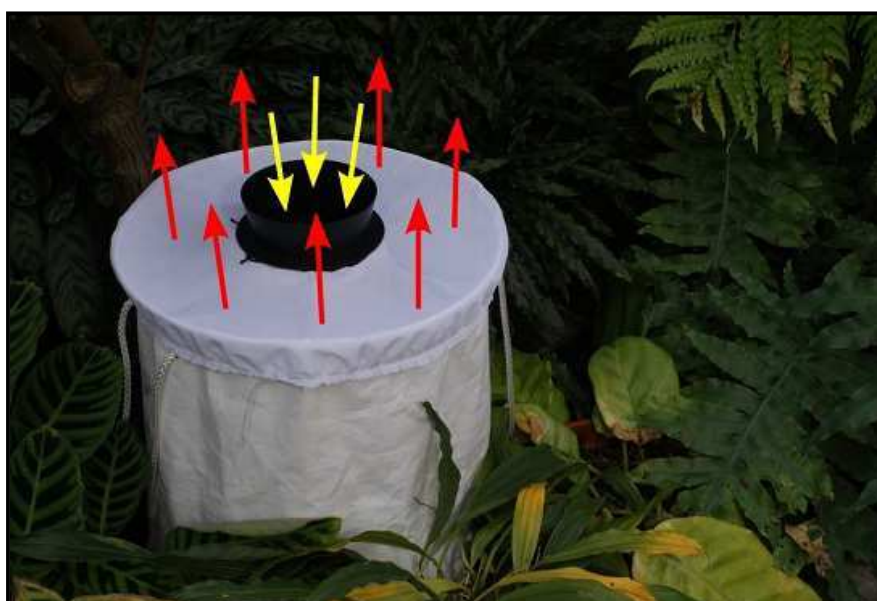
FIGURA 8: Armadilha BG-Sentinel Full Version ® em funcionamento. As setas vermelhas indicam o fluxo de ar gerado pelo ventilador que dispersa os odores do atrativo químico. As setas amarelas indicam o direcionamento dos mosquitos que são atraídos e permanecem próximos ao funil escuro.
