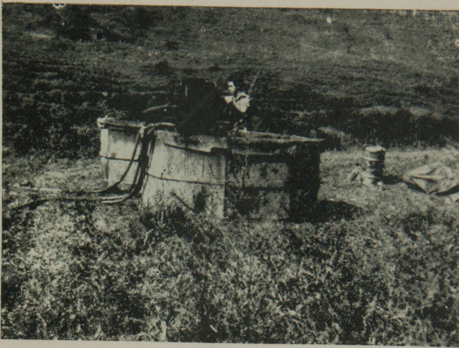
Fig. 1 — As piscinas desmontáveis forradas com lonas impermeáveis, vendo-se a bomba compressora pronta para iniciar o expurgo.
