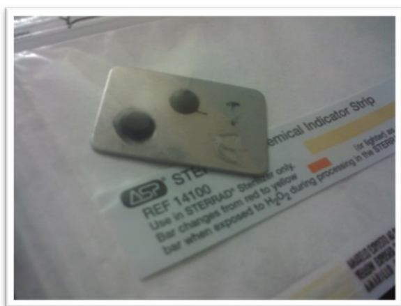
Figura 7 - Sistema ManagerTools . Teste de Esterilização do Plasma de peróxido de hidrogênio.
