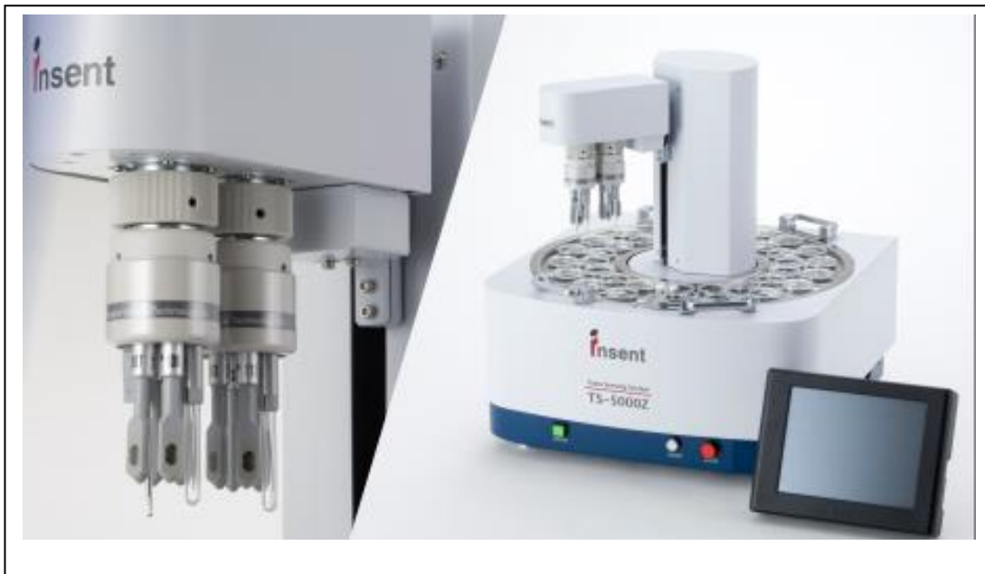
Figura 2: Sistema eletrônico de avaliação de sabor Insent TS-5000Z (Atsugi-Shi, Japão).
