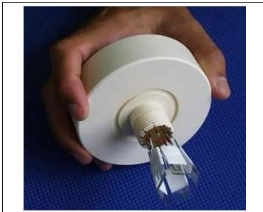
Figura 3: Língua eletrônica utilizada para avaliação de sabor.
