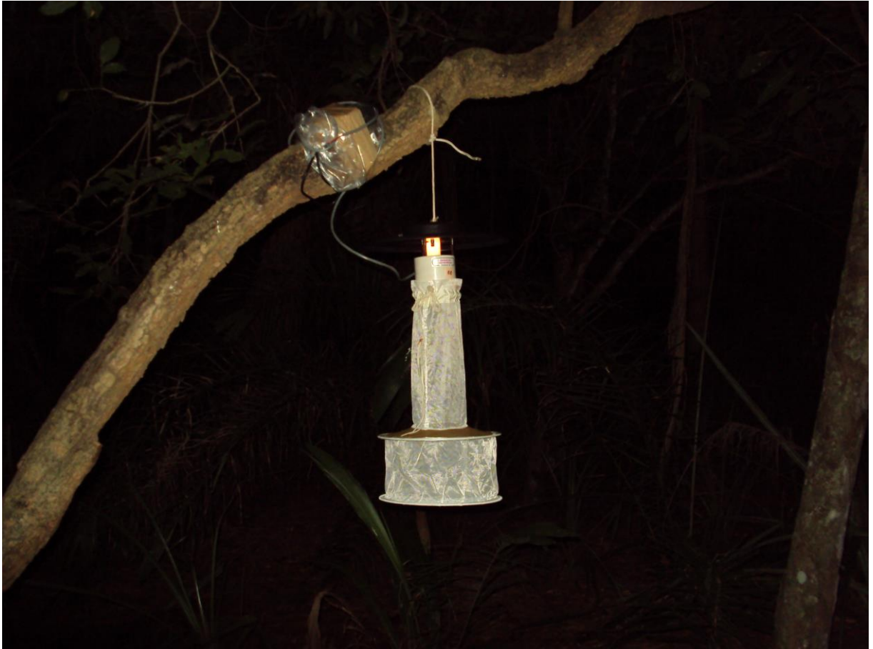
Foto 3.16 – Armadilha luminosa tipo CDC na propriedade PC no Pantanal de MS em 2010. Foto: Alex Pauvalid-Corrêa.
