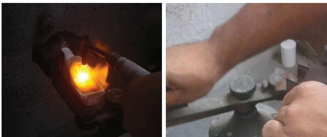
Na foto à esquerda o protético 2 está derretendo uma liga de prata. Na fotografia ao lado, após derreter a liga, ele roda a centrífuga para que a liga em estado líquido vá para o interior do revestimento e posteriormente esfrie, tomando a forma da prótese.
