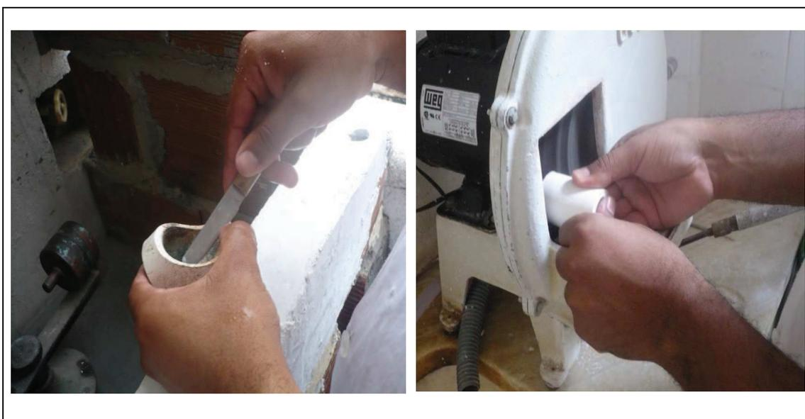
Na foto à esquerda, o protético 2 está removendo restos de folha de amianto usada na fundição anterior sem o uso de EPI. Na foto ao lado, ele usa o cortador de gesso para remover os excessos do revestimento para que ele caiba na centrífuga. Nesse passo, há o risco de cortar o dedo seriamente.
