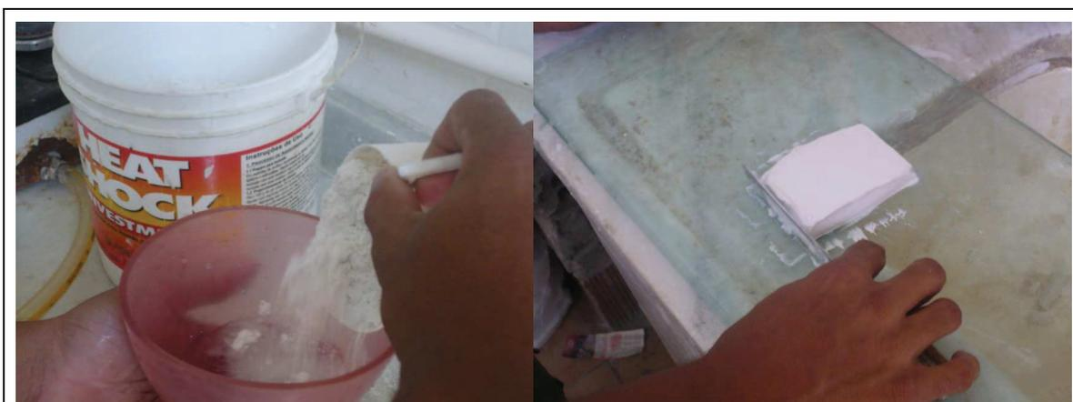
Na foto da esquerda o protético 4 adiciona gesso pedra à água para formar uma massa que servirá de plataforma de trabalho, onde o modelo de trabalho será encaixado. Novamente, nenhum EPI é usado.
