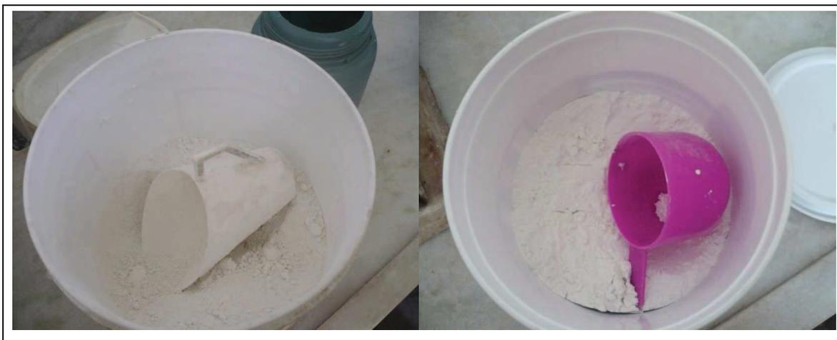
Na foto da esquerda temos o gesso pedra e na direita o material de moldagem alginato. Ambos não são manipulados com EPI e geram uma nuvem de poeira quando são removidos destes recipientes e colocados na cuba de borracha para serem misturados com água.
