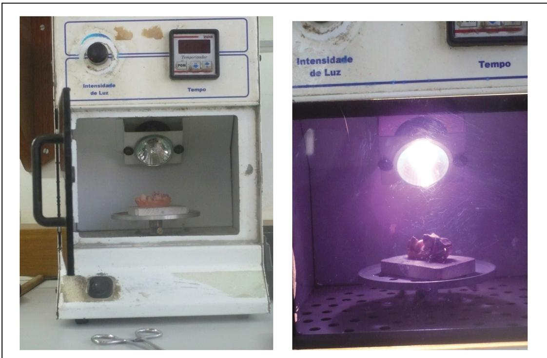
Essas fotos mostram o forno fotopolimerizador e seu funcionamento. A luz é muito forte e emite radiação ultravioleta, e a porta que protege o operador dos malefícios da luz pode ser aberta sem problemas, não há nenhum dispositivo que impeça. Nesse dia, também não houve uso de EPI.
