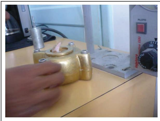
Nestas fotos vemos a confecção de uma prótese flexível pelo protético 4. O material antes de ser inserido na máquina injetora é visto na foto superior à esquerda. A foto da direita mostra o momento da injeção, quando a resina é amolecida pelo calor da máquina, exalando um cheiro muito forte. A foto ao lado mostra o final do processo.
