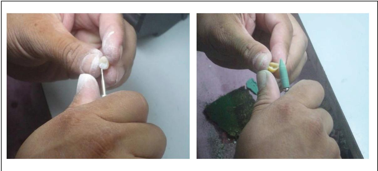
As fotos mostram o acabamento e polimento de uma coroa em cerômero. O protético 3 não usa EPI para realizar estes procedimentos e além da poeira ficar sobre sua mão, ela fica no ambiente e é aspirada com facilidade. A foto da esquerda mostra o acabamento com broca carbide e ao lado ele usa uma borracha. O lixo produzido nesta fase da produção da coroa é “jogado” para uma gaveta.
