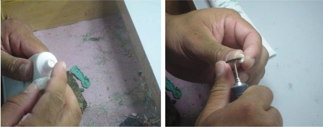
Na foto da esquerda é visto o interior da gaveta com o resto de lixo. Nesse momento, o protético 3 vai polir a coroa em cerômero com pasta de pedra pomes sem EPI. Ele usa uma roda com pelos encaixada em um micro motor de baixa rotação.
