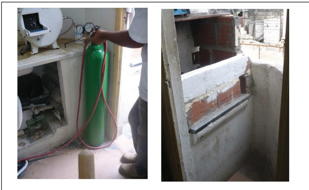
Na foto da esquerda, o protético 2 abre gás comprimido para dar “força” à chama na fundição. O gás comprimido é usado junto com o gás de cozinha. Na foto à esquerda, vemos o local onde é feita a fundição. É um cômodo bastante estreito. Se houver um acidente com a chama, o protético não tem para onde correr.
