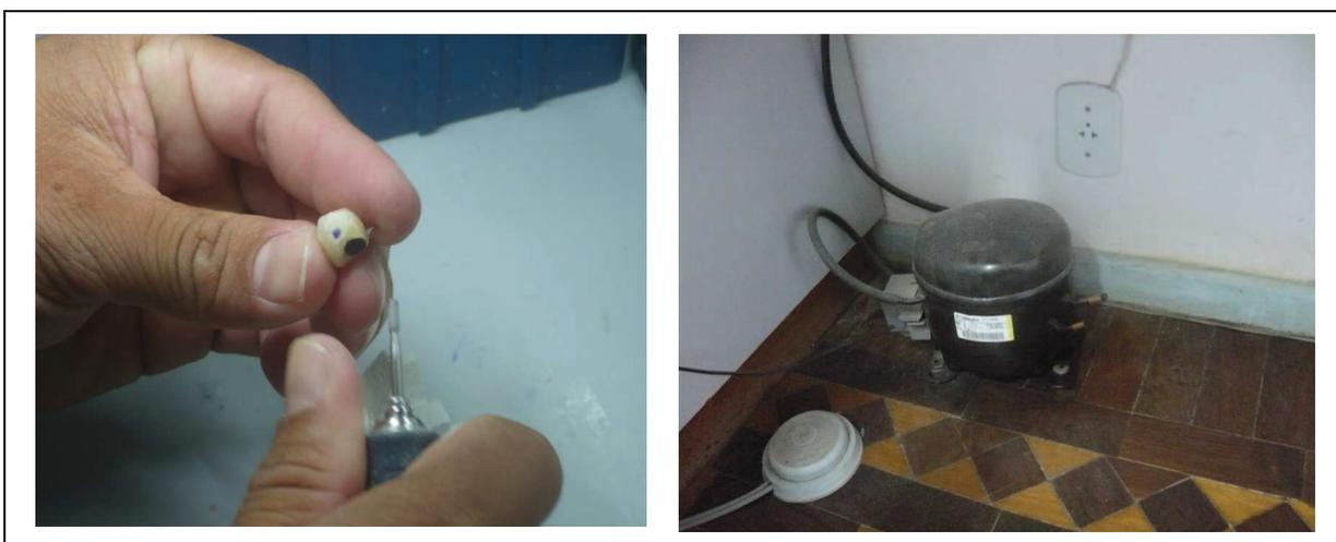
Na foto da esquerda o protético 3 vai dar início ao acabamento da coroa metalo cerâmica com uma broca carbide encaixada em um micro motor em baixa rotação sem o uso de EPI. O compressor da outra foto é o responsável pelo acionamento deste motor e ele fica embaixo da bancada que o protético 1 e 3 trabalham. Apesar de pequeno, é bastante barulhento.
