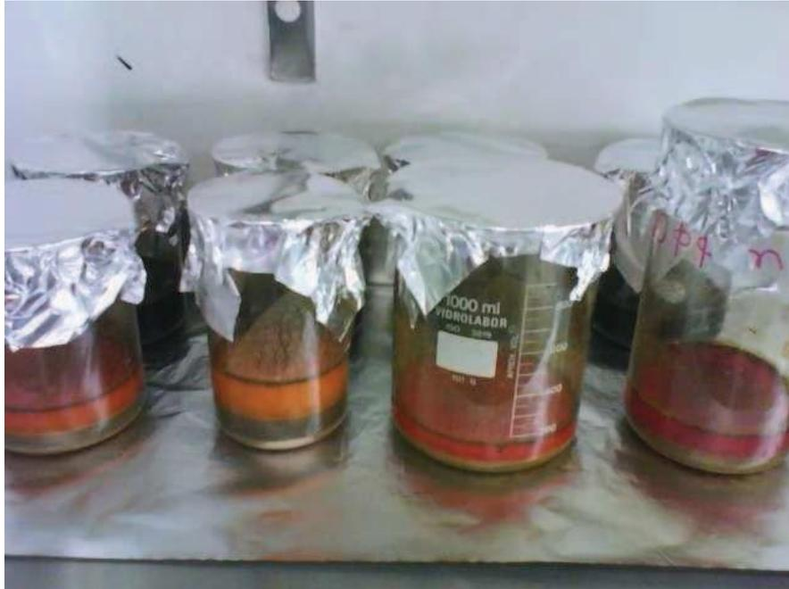
Figura 8: Sedimento impregnado com solução azocorante
