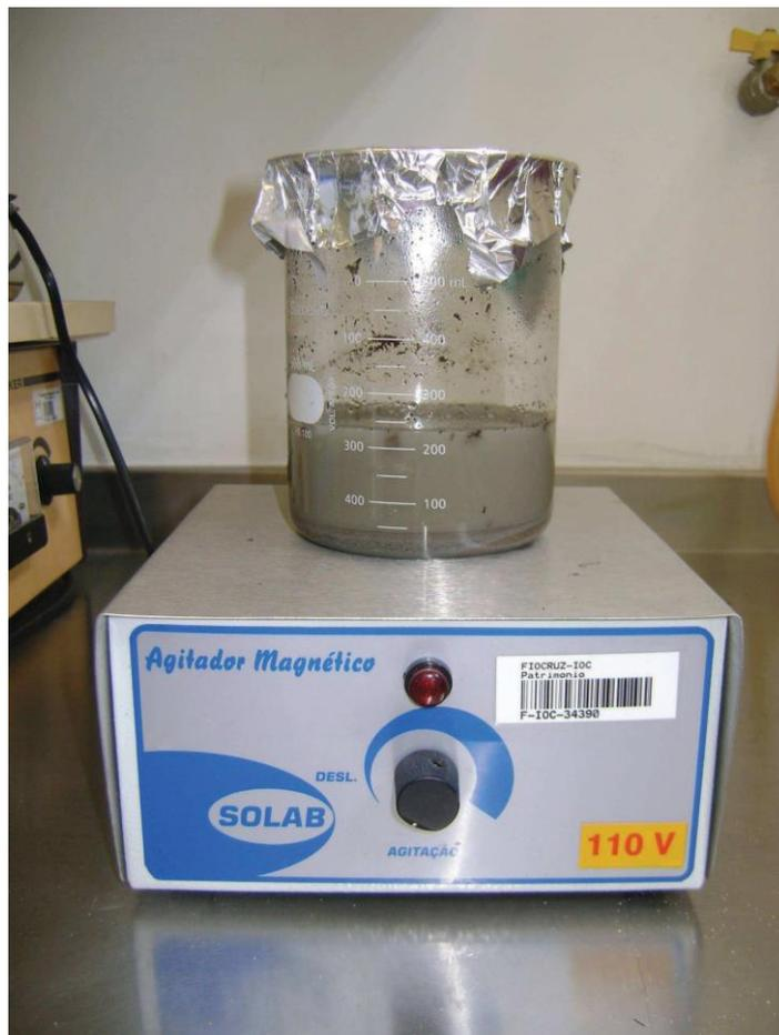
Figura 9: Agitador magnético
