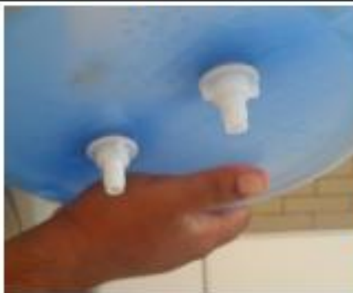
Foto 5. Detalhe da fixação das velas cerâmicas no fundo do garrafão.
