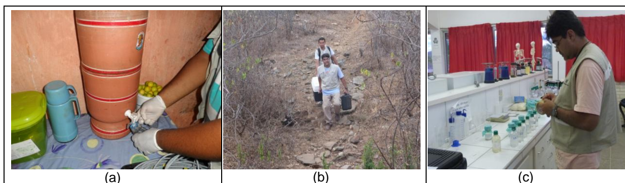
Figura 58. Coleta e transporte das amostras de água de consumo humano. (a) Nos domicílios. (b) Transporte das amostras em caixa térmica. (c) Preparo das frascarias para transporte.
