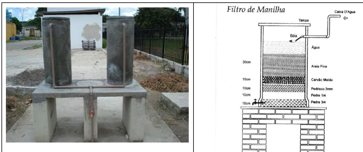
Figura 20. Filtro de areia tipo manilha. (a) Vista do protótipo (b) Corte esquemático (Fonte: Pinheiro 2005).
