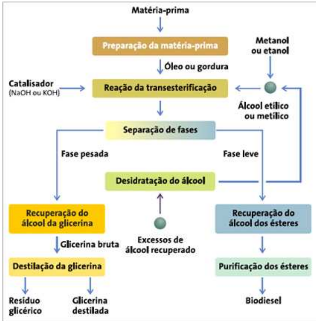
Figura 3 - Fluxograma do processo de fabricação do biodiesel Fonte: Parente, (2003).
