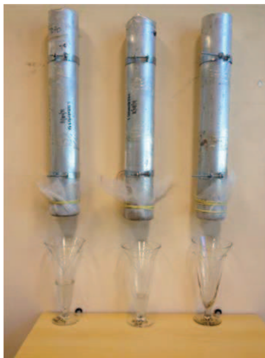
Figura 23 – Tubos de alumínio contendo colunas de sedimento arqueológico fixados à parede do laboratório para teste de percolação vertical de ovos de Ascaris lumbricoides . Foto: Victor Hugo Borba.
