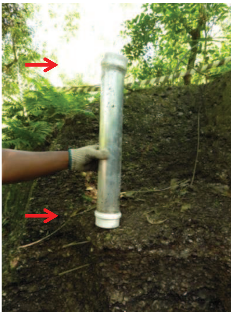
Figura 16 – Tubo de alumínio contendo coluna de sedimento arqueológico indeformado. Destaque para a vedação nas partes superior e inferior do tubo. Foto: Morgana Camacho.
