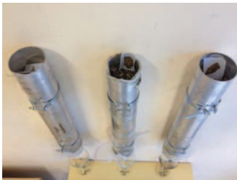
Figura 24 – Fezes introduzidas na superfície do sedimento contido nos tubos de alumínio fixados a parede para teste da percolação vertical dos ovos de Ascaris lumbricoides . Foto: Morgana Camacho.
