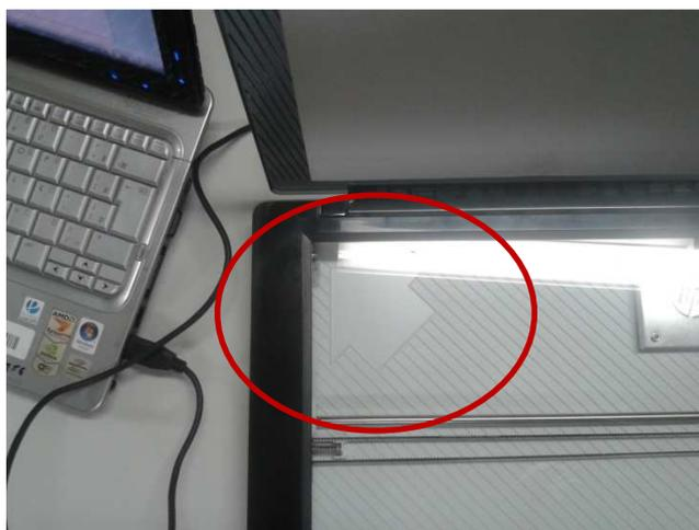
Figura 19 – Seta interna do scanner para posicionamento da imagem a ser digitalizada.
