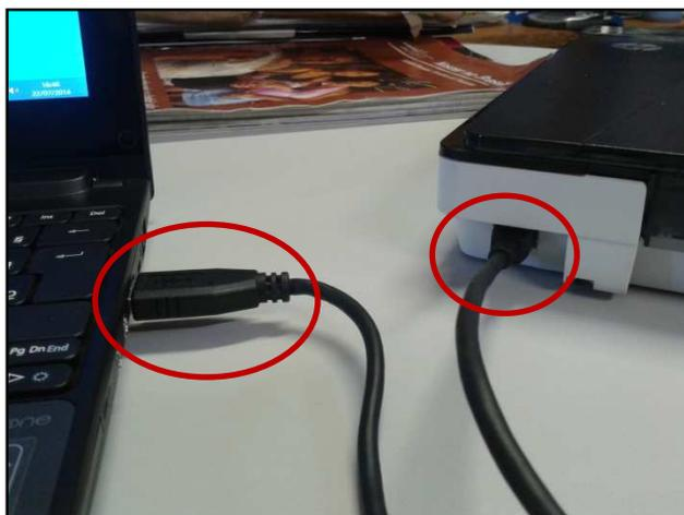
Figura 18 – Conexão do cabo UBS no computador e no scanner
