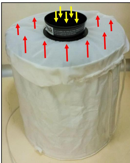
**Figura 12-** Armadilha BG Sentinela. As setas indicam o fluxo de ar, as amarelas, a entrada de ar e as vermelhas, a saída.
