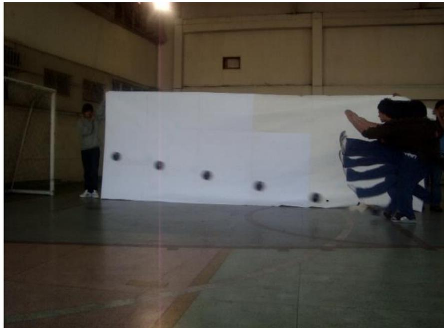
**Figura 4:** Fotografia estroboscópica do movimento de uma bola após ser chutada por um aluno nas mesmas condições que a figura anterior. As distâncias entre duas posições consecutivas são proporcionais à velocidade da esfera, que, nesse caso é quase o dobro da figura anterior.
