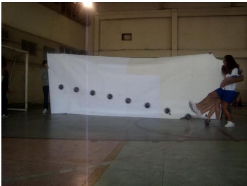
**Figura 2:** *Fotografia estroboscópica do movimento de uma bola após ser chutada por uma aluna. As distâncias entre duas posições consecutivas são proporcionais à velocidade da esfera.*
