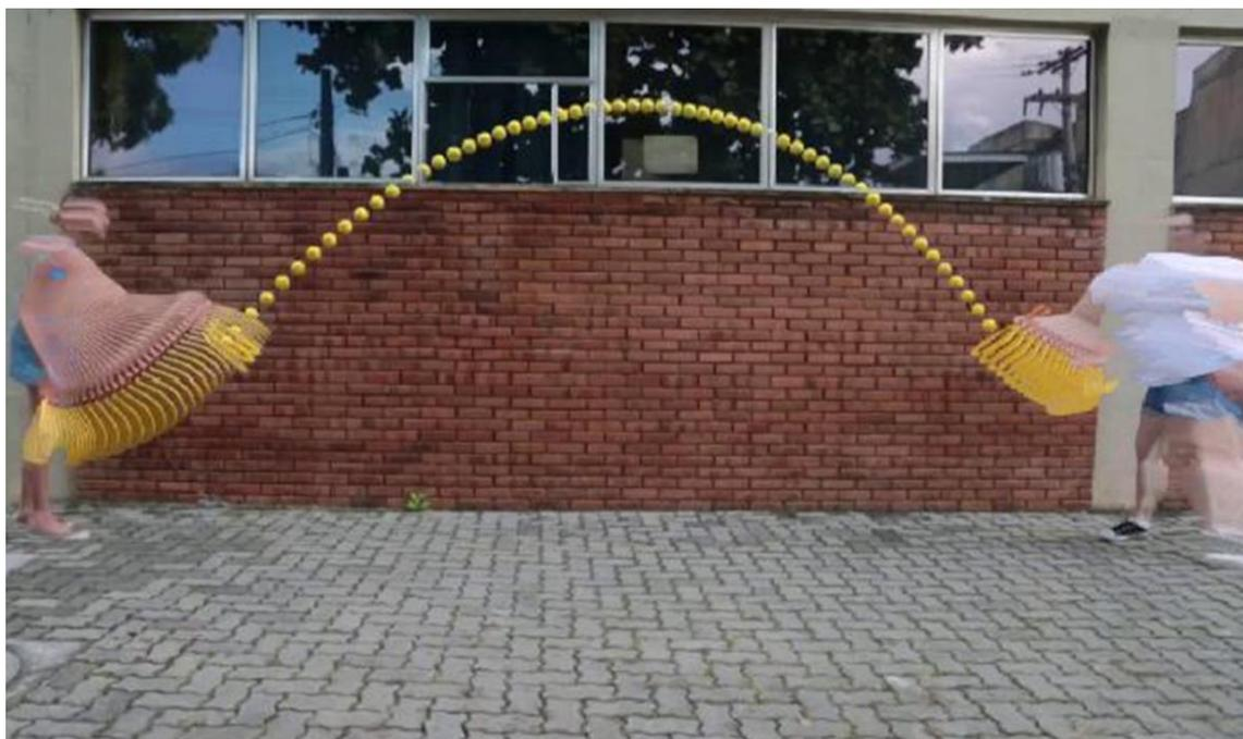
Figura 23 – Imagem estroboscópica do movimento de uma bola de frescobol
