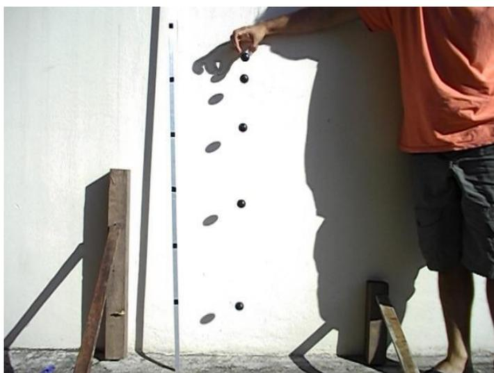
Figura 1 – Fotografia estroboscópica de uma esfera em queda livre.
