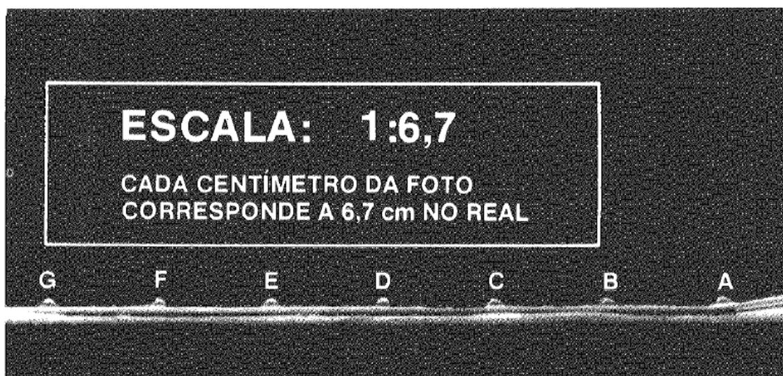
Figura 18 – Imagem estroboscópica de uma bolinha se deslocando sobre uma canaleta, proposta pelo Projeto Ensino de Física (PEF) da USP. Fonte: PEF.
