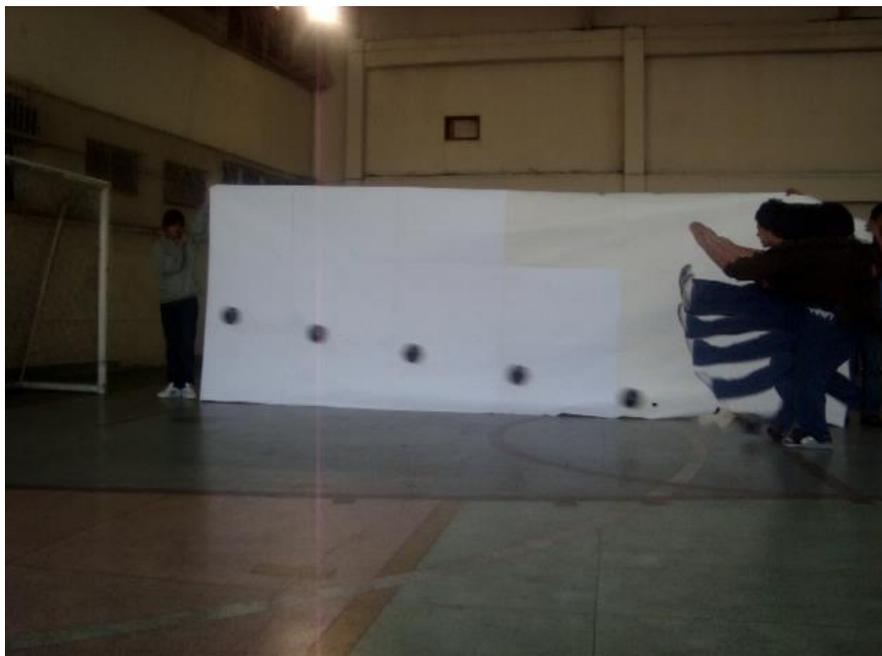
**Figura 2:** *Fotografia estroboscópica do movimento de uma bola após ser chutada por um aluno nas mesmas condições que a figura anterior. As distâncias entre duas posições consecutivas são proporcionais à velocidade da esfera, que, nesse caso é quase o dobro da figura anterior.*
