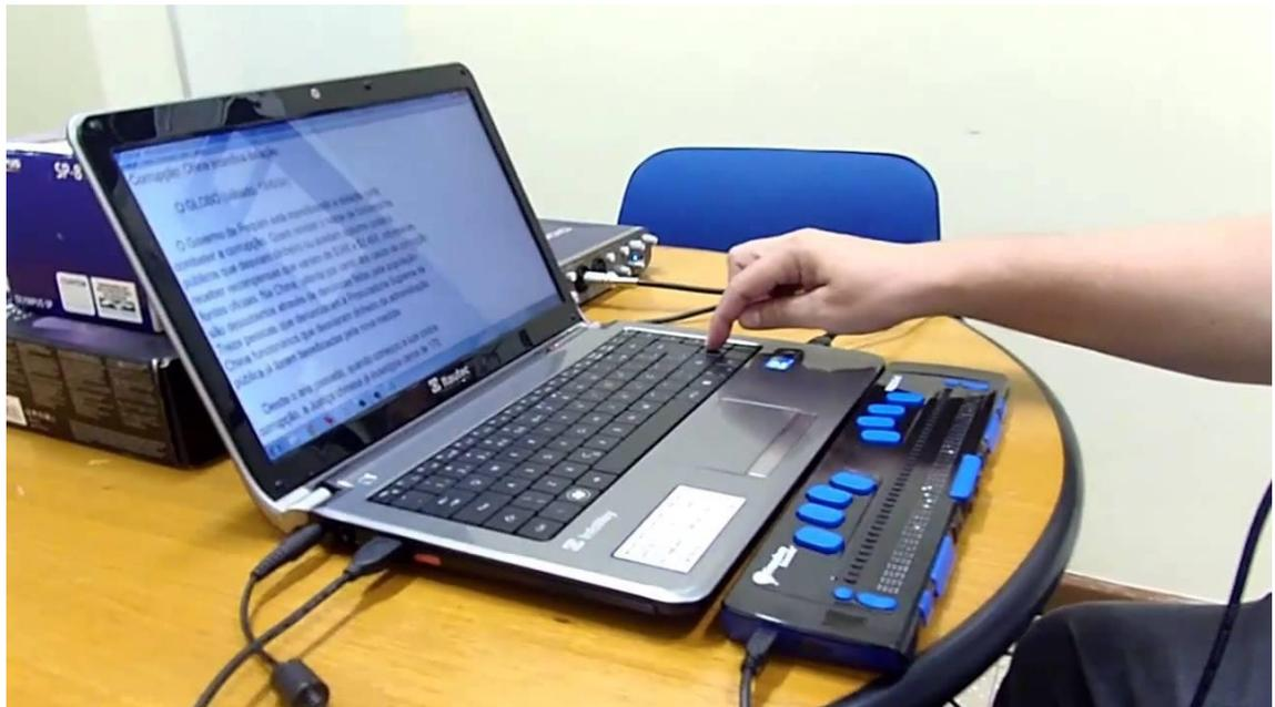
**Figura 6** - Linha Braille conectada a um computador do tipo *laptop*
