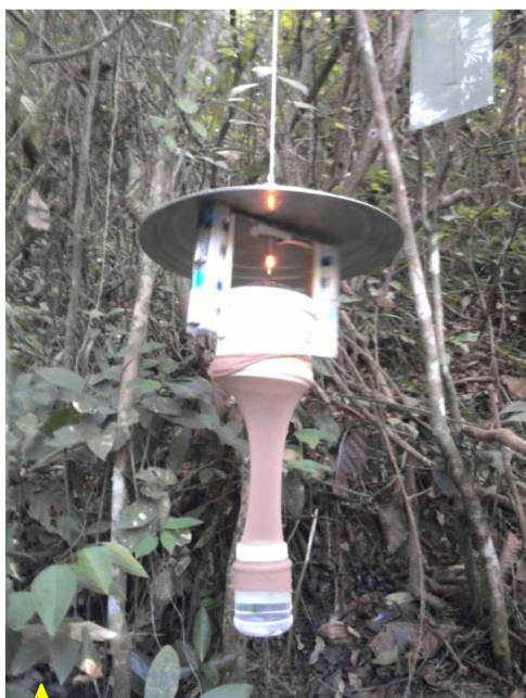
Figura 4.5 – Fotos das armadilhas luminosas modificadas: A – armadilha instalada na mata do ponto 1 (Itaipuaçu); B – armadilha instalada no galinheiro (ponto 5) da residência em Itaipu.
