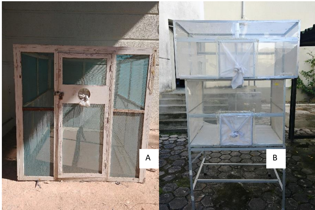
Figura 6 – Gaiolas utilizadas nos testes de dispersão de pyriproxyfen por fêmeas de Aedes aegypti .
