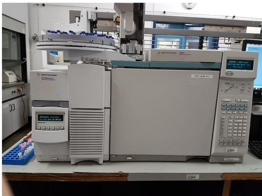
Figura 15. Cromatógrafo a gás acoplado a um espectrômetro de massa (CG-EM - Plataforma Farmanguinhos, Fiocruz)
