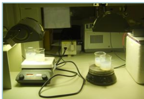
Figura 8 – Reator com lâmpada de vapor de mercúrio utilizada nos experimentos de fotodegradação do agrotóxico acetamiprida.
