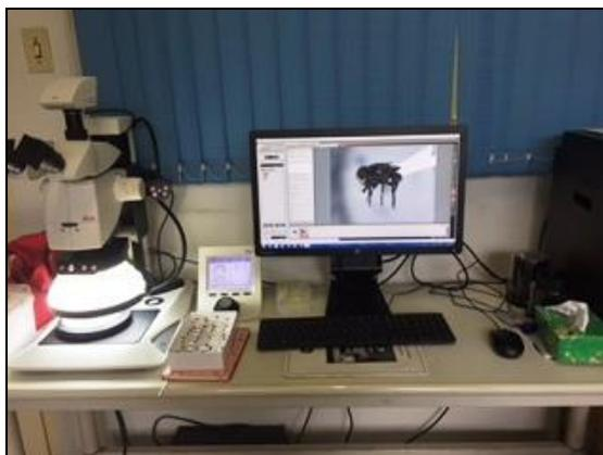
**Figura 19** - Estereomicroscópio acoplado a uma câmera fotográfica digital e ao computador localizado na Coleção Malacológica do Instituto Oswaldo Cruz (CMIOC).
