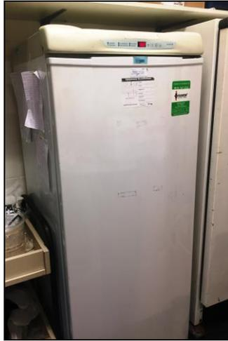
**Figura 11 - Câmaras climatizadas (B.O.D.) com temperatura e umidade regulada a  $22 \pm 1$  e  $32 \pm 1$  °C, umidade relativa de  $60 \pm 10$  % e 12 h de fotofase onde os experimentos foram mantido, em condições de laboratório.**
