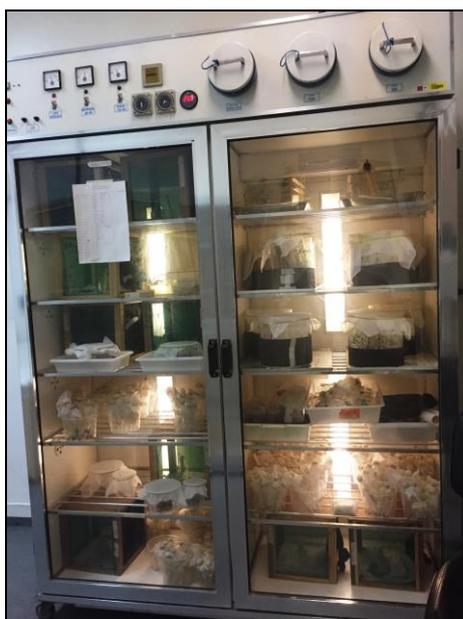
Figura 10 - Estante ventilada com temperatura e umidade regulada a  $27 \pm 1$  °C,  $70 \pm 10$  % URA e 12 h de fotofase onde os experimento foram mantido, em condições de laboratório.
