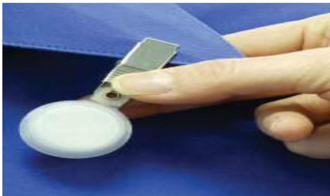
Figura 11: Amostradores passivos SKC-575-001, utilizado na amostragem de BTEX
