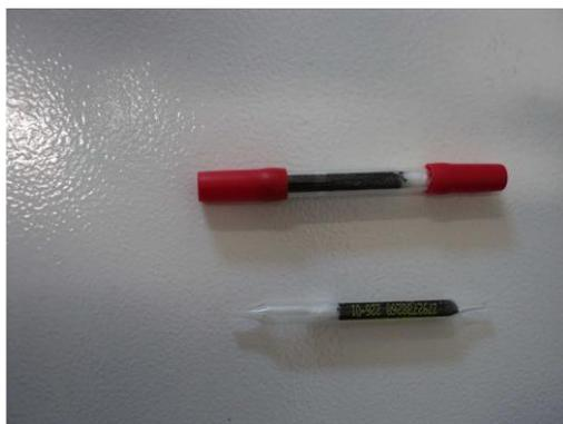
Figura 10: Tubos amostradores Anasorb-CSC (100 mg / 50 mg) utilizados na amostragem de BTEX
