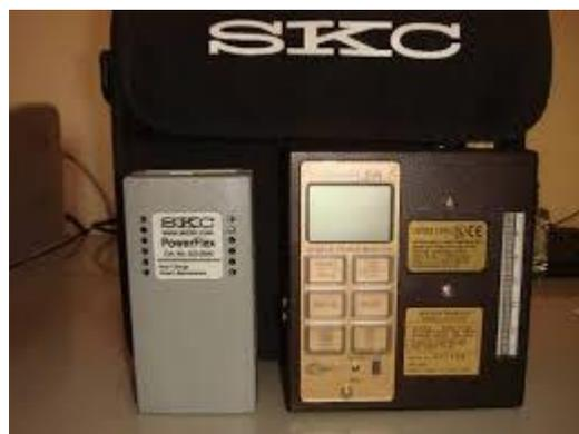
Figura 9: Bomba amostradora Anasorb CSC SKC PCXR4, utilizada na amostragem do BTEX
