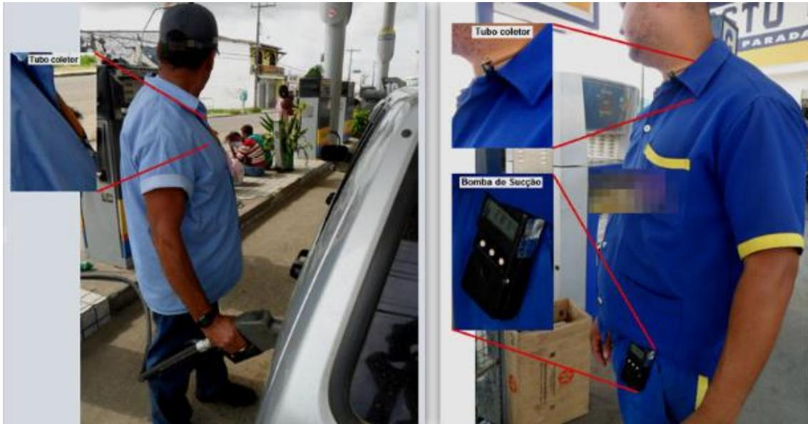
Figura 8: Coleta de BTEX utilizando a amostragem ativa nos frentistas (SANTOS, 2014).
