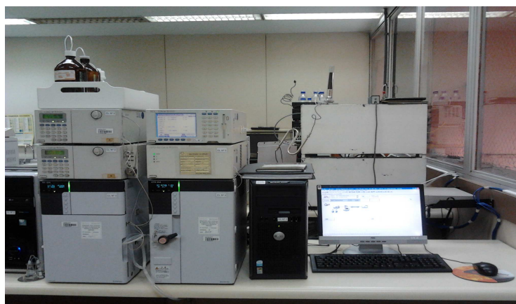
Figura 5: Cromatógrafo líquido, fabricante Shimadzu com detector ultravioleta-visível e conjunto de fotodiodos usado em todas as etapas da validação.
