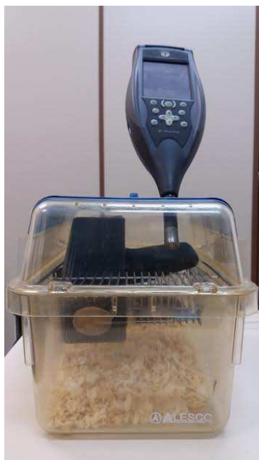
Figura 8: Medidor es posicionados dentro do mini-isolador.
