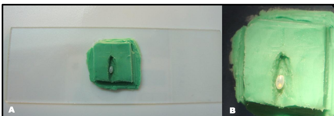
Figura 4- Suporte feito com massa de modelar sobre lâmina de vidro, utilizado para a medição dos ovos (A). Zoom (B).
