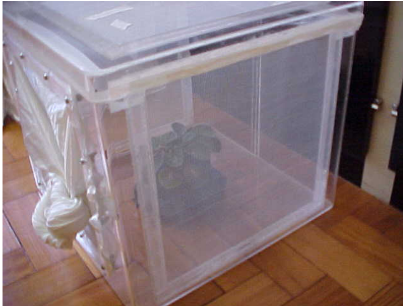
Figura 3.4 - Gaiola entomológica de acrílico transparente, tampada e lacrada com fita adesiva para evitar a evasão das fêmeas pelo ambiente, contendo em seu interior vaso de violeta coberto pela evidengue e 30 fêmeas de Ae. aegypti após repasto sangüíneo.
