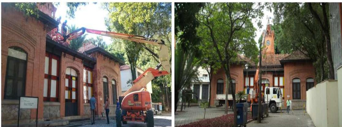
Figura 46: Caminhão plataforma e guindauto da COGEC. Fonte: Autor, 2018.
