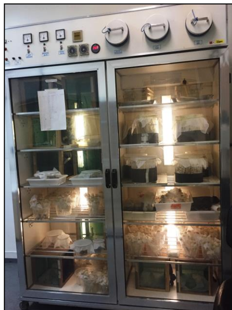
Figura 11 - Estante ventilada com temperatura e umidade regulada a 27 \pm 1^\circ\text{C} , 70 \pm 10\% URA e 12 h de fotofase onde o experimento foi mantido.
